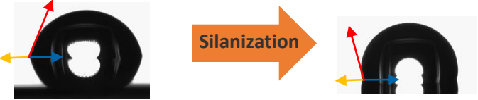
Effekt der Hydrophobisierung auf Si-Wafer
